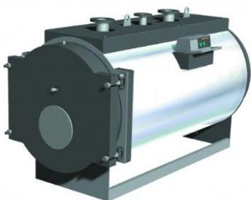
Стальной водогрейный котел с топкой под давлением, поставляется в готовом к работе виде со струйной горелкой на жидком или газовом топливе. Полностью охлаждаемая камера сгорания, размер которой подобран для обеспечения низких тепловых нагрузок. Топка с реверсивным факелом и низкой тепловой нагрузкой. Линия состоит из 25-ти моделей с тепловой мощностью от 2360 кВт до 6 000 кВт.
