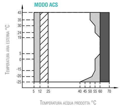
Campo di funzionamento con pompa di calore con possibile limitazione e protezione
