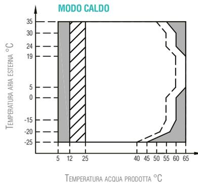
Campo di funzionamento con pompa di calore con possibile limitazione e protezione
